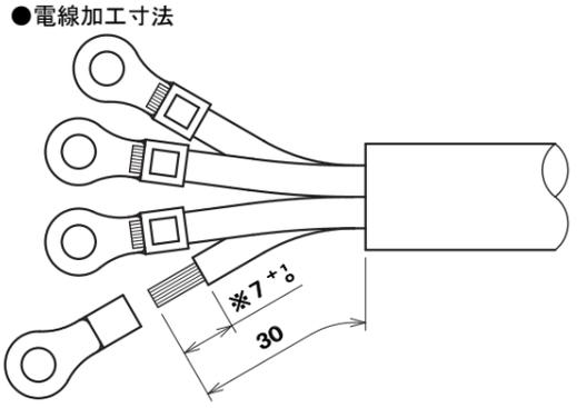
※被覆剥き寸法の7<sup>+0</sup>/<sub>0</sub>は3.5mm<sup>2</sup>のものであり、5.5mm<sup>2</sup>は8<sup>+0</sup>/<sub>0</sub>とする。
